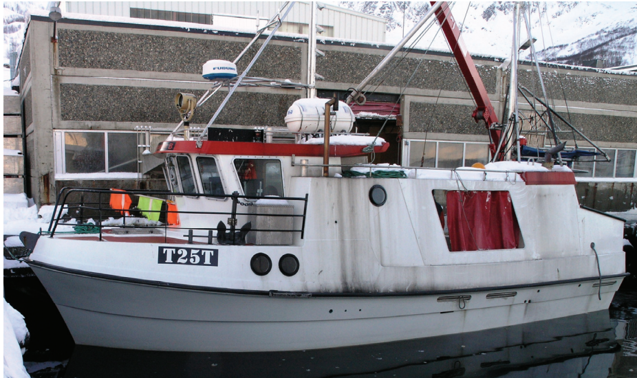
Figur 3 "Sigurdur B" (T-25-T). Fartøyet er 12,11 langt og 3,93 m bredt med en motor på 190 hk.
